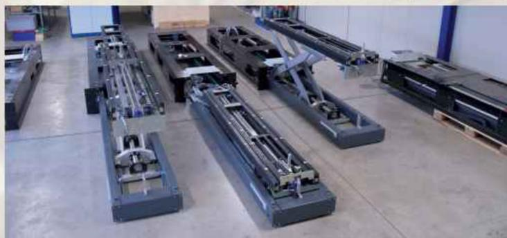
Depuis 2006/2007, DFW Europe commercialise une Machine d'Enfournement Automatique (AIM) qui n'a pas son égal sur le marché. Installée sous le four, elle apparaît uniquement au moment de l'enfournement. Cette machine permet d'enfourner d'une façon ergonomique les cercueils d'un poids jusqu'à 250 kg, même à des températures de four dépassant les 650°C.
